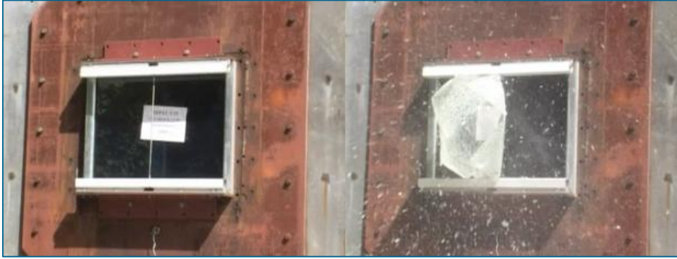
Figuur 3.6.3c: De werking van een stalen stang en glas bij een explosie.
