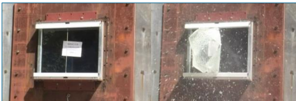
Figuur 3-4: Het opvangsysteem voor en na een blasttest.
