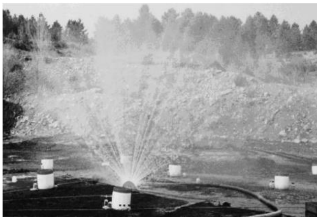
Figuur 2.3 Gebruikt waterscherm in de test
