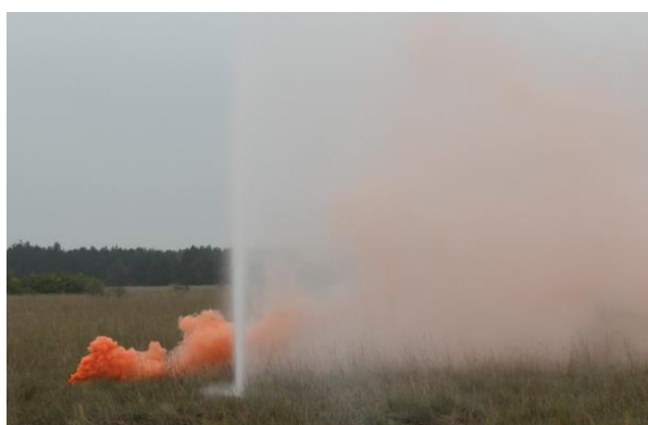
Figuur 2.14 Gebruik van tracerdeeltjes bij een test met een waaivormig waterscherm
